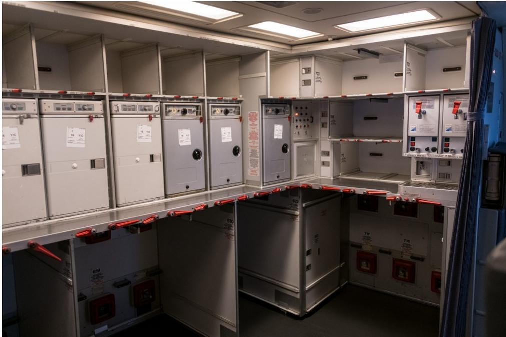
Vista del galley posterior de un Boeing 767 de pasajeros durante un vuelo de carga, todos los compartimentos de alimentación vacíos.
